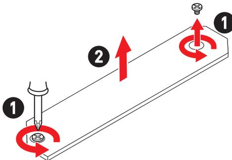
3. Installieren Sie das mitgelieferte EZ M.2 Clip-Kit, bevor Sie die 2242/ 2260 SSD installieren. Überspringen Sie diesen Schritt, wenn Sie eine 2280 SSD installieren.
