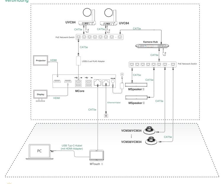
Verbinden Sie den Switch nicht mit dem Internet; dies kann zu zu Netzwerk-Anomalien führen.
