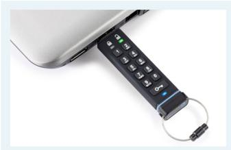
3. Schritt: Zum Sperren herausziehen
